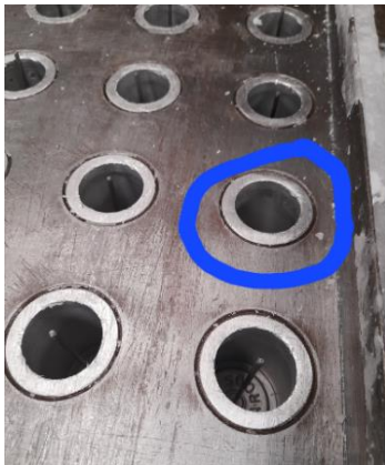
Figura 20. Maquina falta de varillas.
