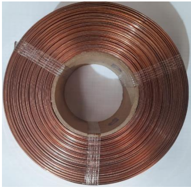
Figura 12. Rollo e grapa embobinado correcto.
